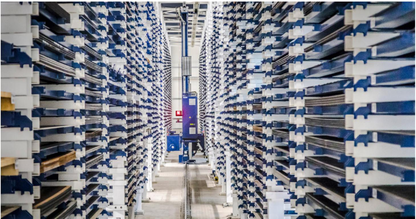
*STOPA-Lager, das vollautomatische Palettenlager war ein großer Schritt nach vorn bei der Prozessautomatisierung*
